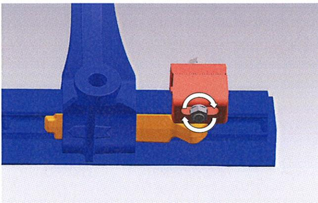
Når kilelåsen er på plass, trekkes mutteren til med et moment på 140 Nm (14 kgm).
