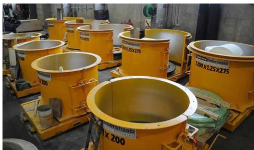
Formutstyr til støp av Brilljant kummer
