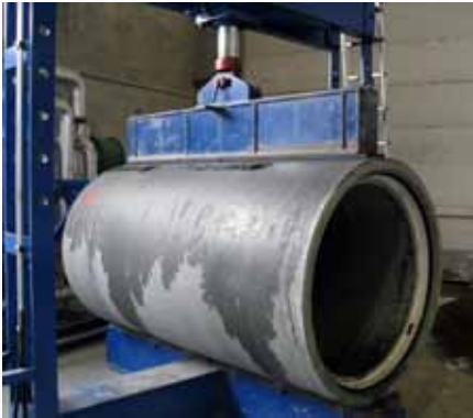
Styrkeprøving av betongrør etter "linjelastmetoden"
