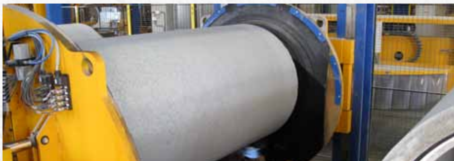
Automatisk tetthetskontroll for ig-falsrør DN 300 til DN 1200
