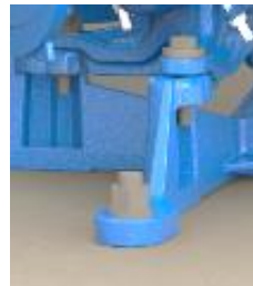
Armatur/konsoll M24 bolt med skive og mutter. Konsollen har Quick fix mutterfiksering for enklere tiltrekking av bolter
