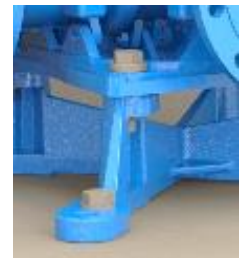
Armatur/konsoll M24 bolt med skive og mutter. Konsollen har Quick fix mutterfiksering for enklere tiltrekking av bolter
