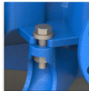
Armaturodim/konsoll M24 bolt med skive og mutter. Mutteren blir fiksert til konsollen.
