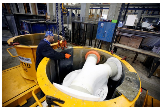
Spesialtilpasset EPS-kjerne settes inn i formen og klargjøres for støp.
