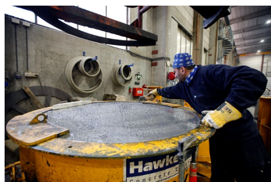
Formen med EPS-kjernet fylles med selvkomprimerende betong for å oppnå best mulig resultat.
